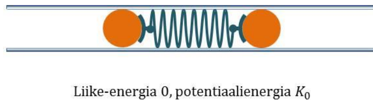
Kuva 15 d: Pallot ääriasennossa, kierrejousi kasassa .
