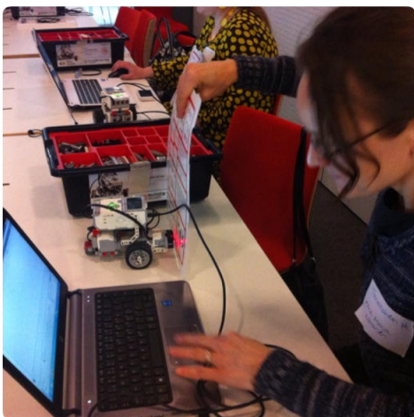
Opettaja tutkimassa ultraäänisensorin ja sitä lähestyvän kohteen tuottamaa graafia.
