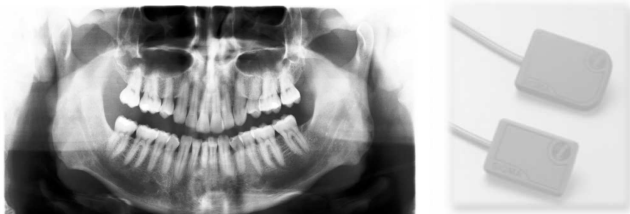
Kuva 3: Röntgenkuvausta Instrumentarium Imaging -yhtiössä, jossa filmit (vasemmalla) korvataan digitaalisilla sensoreilla (oikealla).
